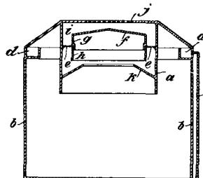
Patent 153330 (Zusatz zum Patent 126672) geschützten Apparates zur Gewinnung von Fett aus Abwässern, dadurch gekennzeichnet, daß der innere Behälter (a) auf dem ganzen Umfange seiner Innenwandung mit einem nach oben geneigten Ansatz (k) ausgestattet ist. —
